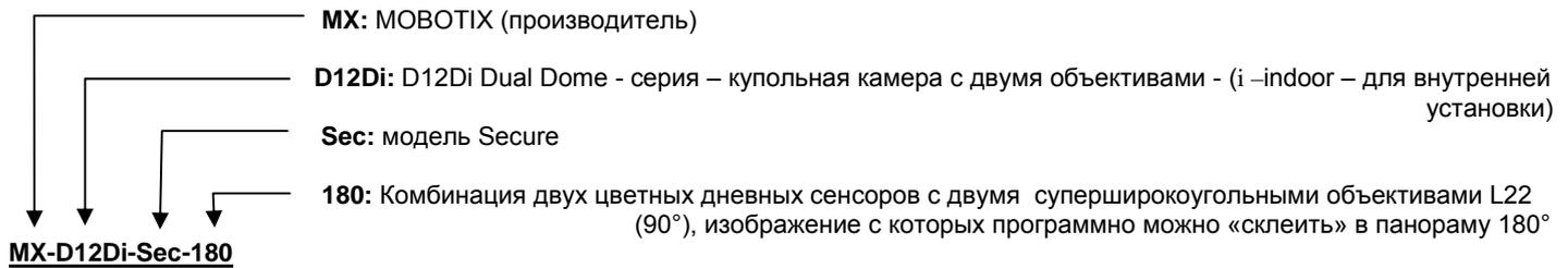
Камеры серий D24M и M24M доступны к заказу без предустановленных объективов. В таком случае в артикуле не указывается последняя аббревиатура, соответствующая типу объектива. Артикул ночных камер включает слово “Night” (например, Sec-Night, IT-Night).
